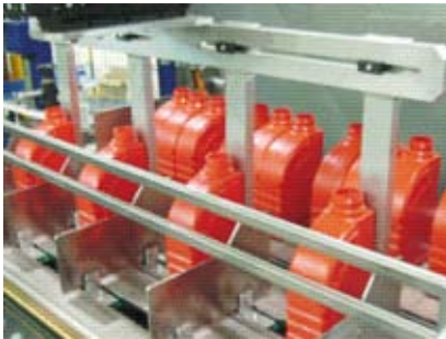
Módulo de incorporación de los envases a la línea de avance paso a paso.
