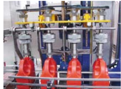
Módulo de roscado con 4 cabezales.
