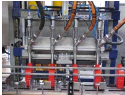
Módulo de envasado con 4 cañas.
